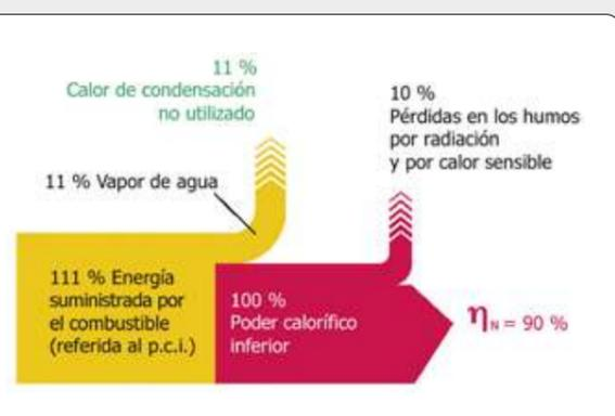
Rendimiento de una caldera convencional funcionando en instalación con temperaturas ida/retorno de 75/60°C
