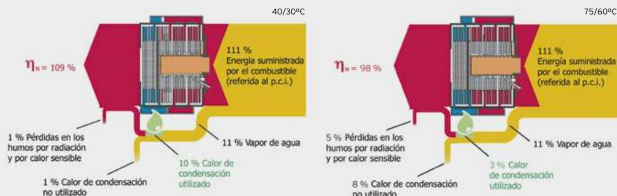
Partiendo de la misma cantidad de energía disponible (gas + vapor de agua en productos de la combustión), bajo las mismas condiciones de instalación el rendimiento es superior siempre con calderas de condensación. Si se mejora las condiciones trabajando a más bajas temperaturas, con grandes paneles de radiadores o con suelo radiante, y con una regulación opcional adecuada, el rendimiento aumenta.
